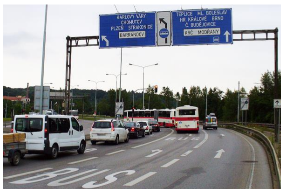
Efektivní řešení preference v křižovatce: kombinace vyhrazeného řadicí pruhu a levé odbočení BUS na speciální fázi s vysokou mírou preference na SSZ (křižovatka Modřanská x nájezd na Barrandovský most, Praha)
