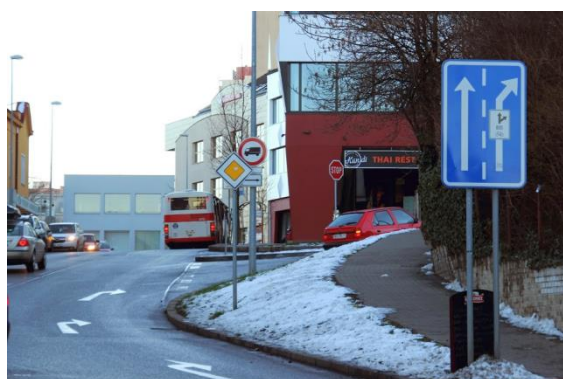
Příklad výlučného směru v řadicím pruhu (Michle, Praha)
