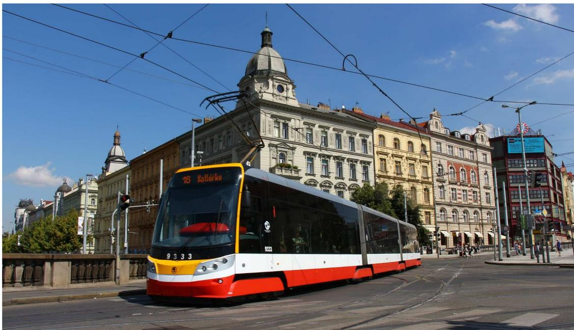
*Dodávky tramvají typu 15T v posledních letech vedou k výraznému zvýšení komfortu cestování v pražské MHD. Celkem Praha získá 250 moderních 100 % nízkopodlažních tramvají, polovina z tohoto počtu je vybavena klimatizací.*
