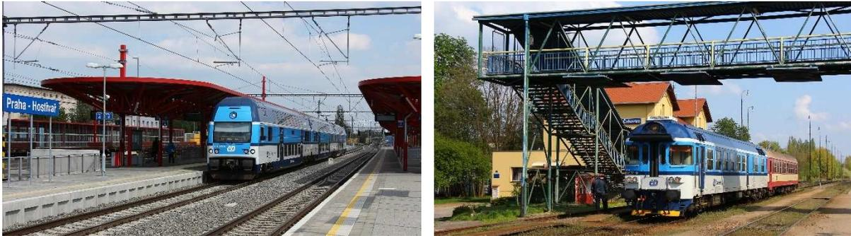
*Vlakové linky S plní funkci páteře systému PID, mezi jednotlivými linkami jsou ovšem stále velké rozdíly. Zatímco například linka S9 (vlevo) je obsluhována výhradně moderními nízkopodlažními jednotkami 471 po vesměs modernizované infrastruktuře, na linku S3 (vpravo) je stále nasazován 0% podíl bezbariérově přístupných vozidel, linka je vedena po neelektrifikované jednokolejné trati a je tak svým charakterem velmi vzdálená od pojmu moderní (pří)městské železnice.*
