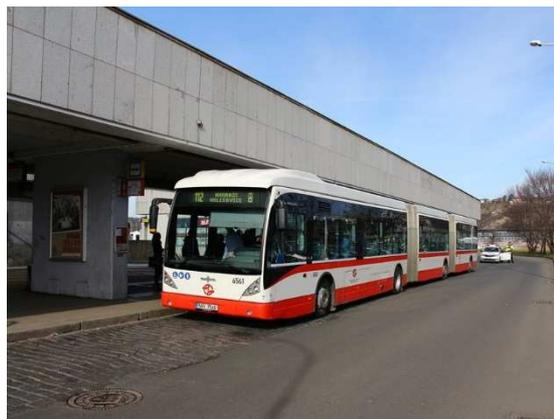
*V letech 2016 a 2017 probíhalo testování vysokokapacitních autobusů v Praze. Zkoušek se zúčastnil jak kloubový 21m autobus Mercedes, tak dvoukloubový autobus Van Hool. Zkoušky probíhaly na linkách 112, 119 a 136 s cílem ověřit vhodnost nasazení takových vozidel na vytipované linky.*
