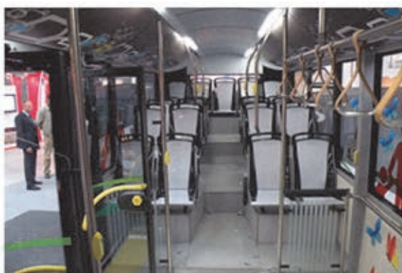
Srovnání interiérů MD 9m vlevo se schody, vpravo MD+ 10,5 s rovnou podlahou pro stání až ke 3. dveřím
