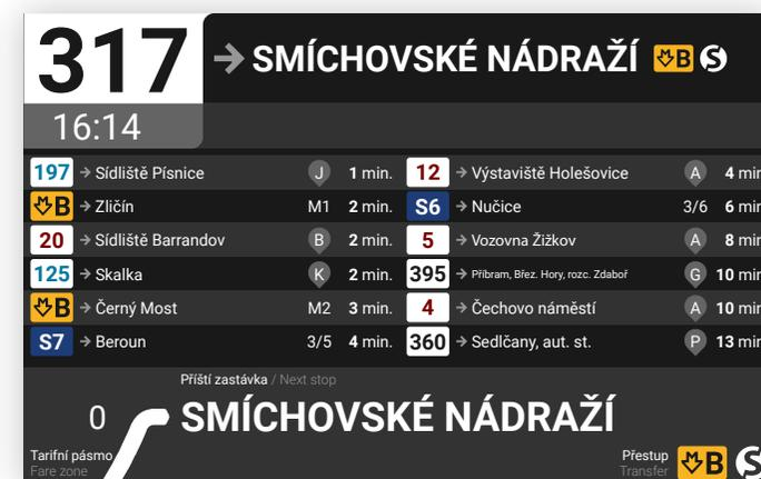
V mezizastávkovém úseku se přepíná ze základní obrazovky (střídají se v poměru 10 a 10 s). Po vyhlášení konkrétní zastávky se přepne zpět na základní obrazovku.
