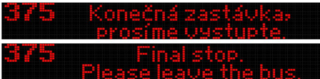
**Obraz 6:** s vyhlášením zastávky; doba zobrazení **4 s**; periodicky se střídá s následujícím obrazem.
