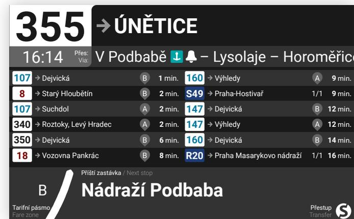
3. Délka zobrazení přestupní obrazovky je 8 s. Zobrazují se odjezdy do 30 min. od předpokládaného příjezdu do zastávky. Zobrazuje se pouze prvních 12 odjezdů.
