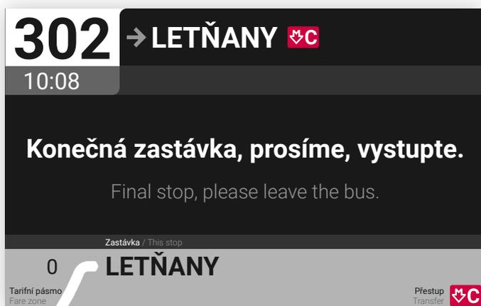
Sdělovací obrazovka se přepíná z obrazovky základní v konkrétních případech (změny tarifního pásma, konečná zastávka, zpráva z dispečinku, informace o výluce apod.). Po uplynutí dané lhůty (nebo po opuštění zastávky či území) se opět přepne do původního zobrazení (základní obrazovka).
