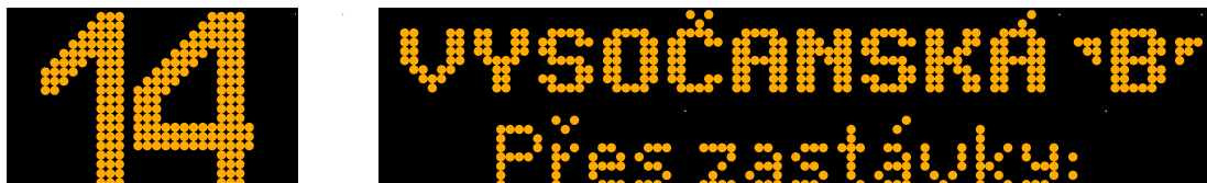
Obrázek 3: Správné použití rozděleného bočního panelu
