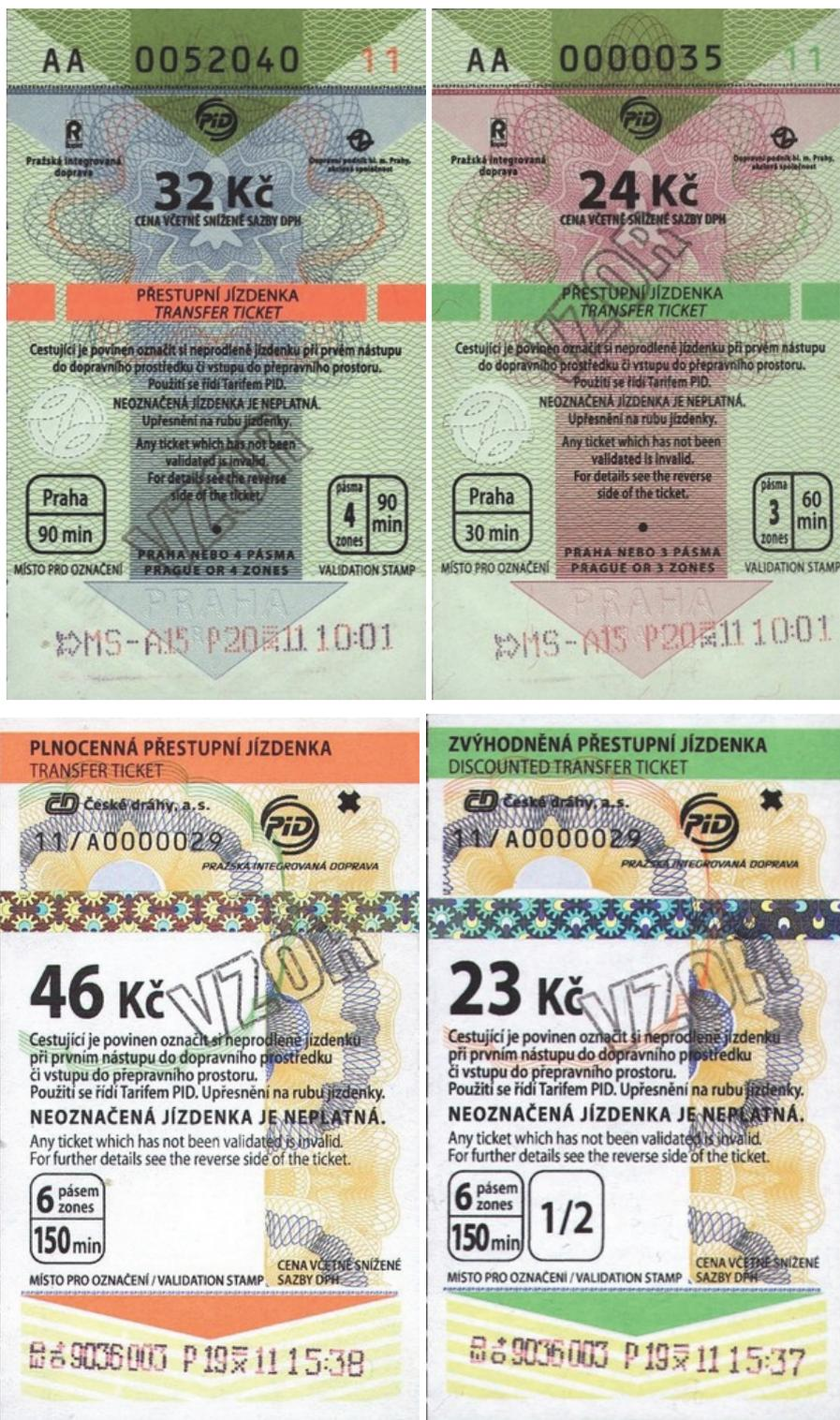
Označovací pole je tvořeno chemicky reagujícími proužky, které způsobí dvoubarevné zabarvení vytištěných údajů po označení. Změna barvy je patrná již 30 sekund až 1 minutu po označení, k úplnému vybarvení dochází přibližně za 5 minut. Údaje z označovače na jízdenkách jsou shodné s údaji uvedenými u jízdenek ze stacionárního automatu. Tyto informace se vztahují ke všem jízdenkám vydávaným v předprodeji.
